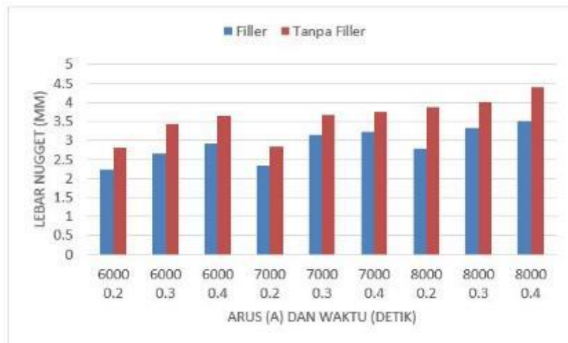
Gambar 9. Histogram pengaruh arus dan waktu terhadap lebar logam las ( nugget ) aluminium
