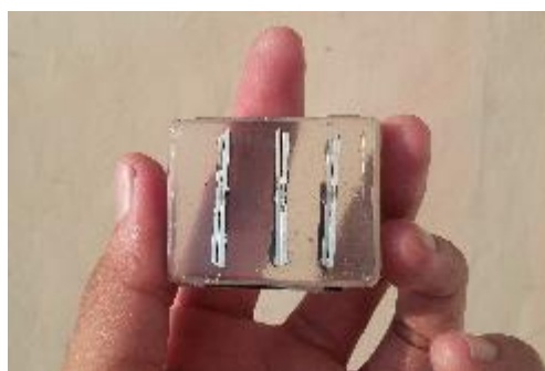
Gambar 7. Spesimen setelah pemotongan dan dimounting
