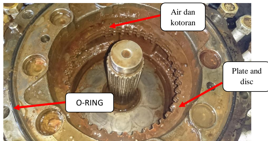
Gambar 4.1 kerusakan o-ring dan plate disc travel motor
