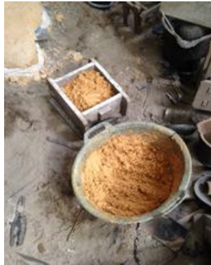
Gambar 4. Mengisi kerangka cetakan dengan pasir silika yang sudah di campur dengan water glass .
