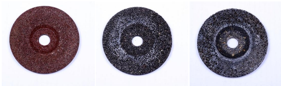
Gambar 13. Batu gerinda pabrikan merek Lippro, batu gerinda tanpa treatment pencucian, batu gerinda dengan treatment pencucian, setelah uji keausan.
