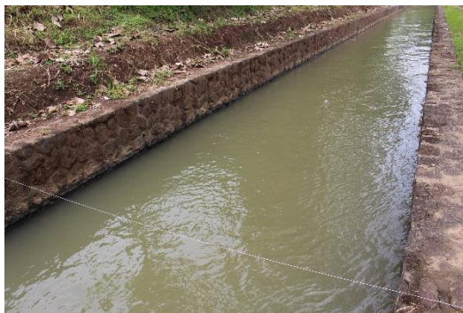
Gambar 7. Pengukuran debit air metode apung
