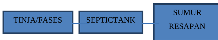
Gambar 22 Skema pembuangan limbah padat
