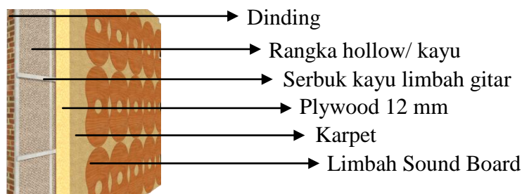
Gambar 5 Lapisan Peredam Pada Dinding Studio
