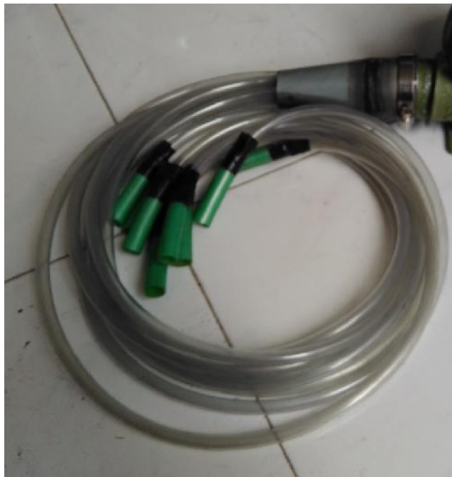
Gambar 3.8. Saluran Pembagi Udara Tambahan
