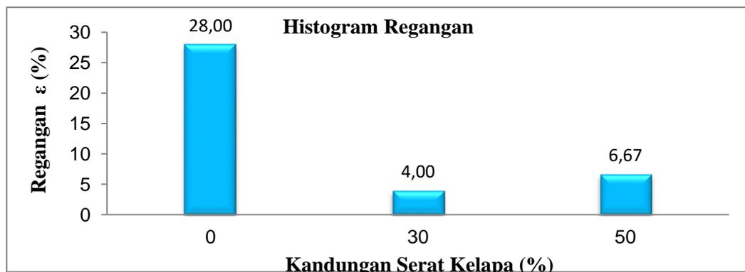
**Gambar 3.** Histogram Regangan Rata - Rata Pada Pengujian Tarik Perpanjangan Putus Komposit
