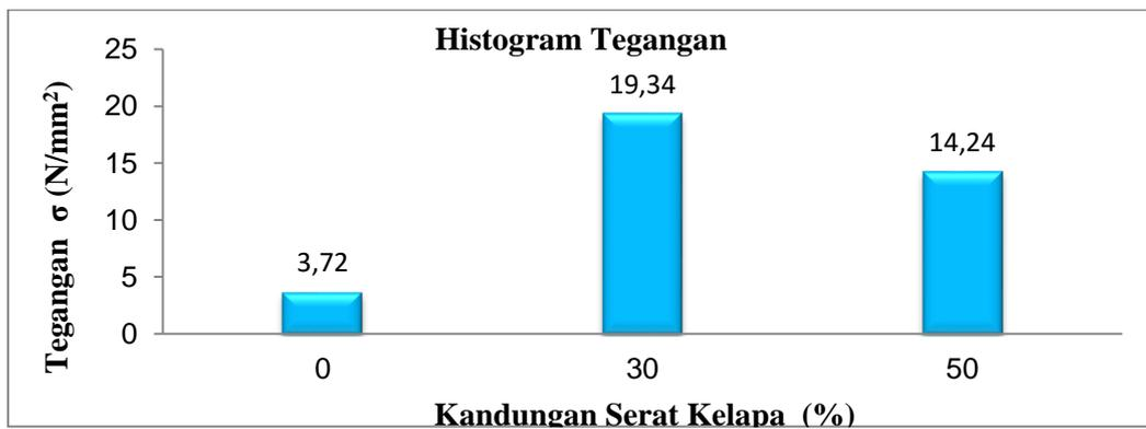
**Gambar 2.** Histogram Tegangan Rata - Rata Pada Pengujian Tarik Perpanjangan Putus Komposit
