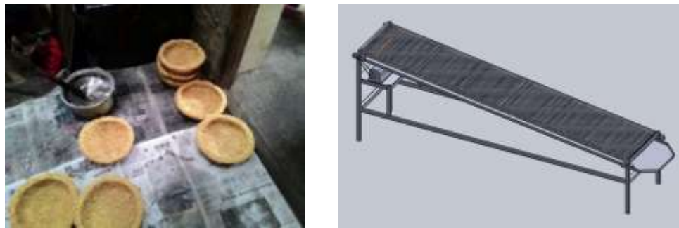
Gambar 7 Aktual peniris (kiri) dan Usulan dengan Conveyor (kanan)
