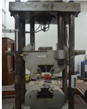
Gambar 5. Thin cylinder uji actual dan alat mesin tekan pada lab Sipil.
