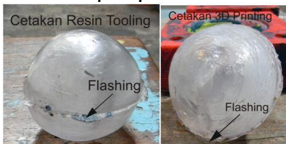
Gambar 11 Cacat produk Flashing pada produk bola
