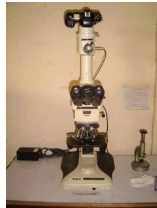
Gambar 16. Mikroskop metalografi Nikon X1005 TTEPL
