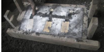
Gambar 6. Pembuatan cetakan pasir ( Fundamentals of Modern Manufacturing -Mikell P. Groover 2010 )
