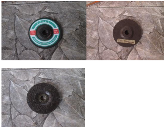
Gambar 5. Batu gerinda variasi ukuran fiberglass 3 mm dan 5 mm dan batu gerinda pabrikan merk voxel
