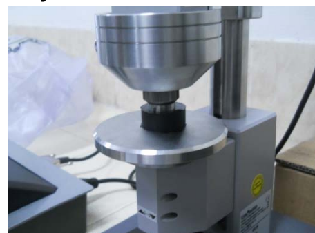
Gambar 21. Pengujian kekerasan Shore A (subtech, 2013)
