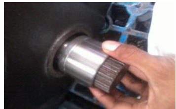
Gambar. 7 proses pelepasan baut pada lifting arm
