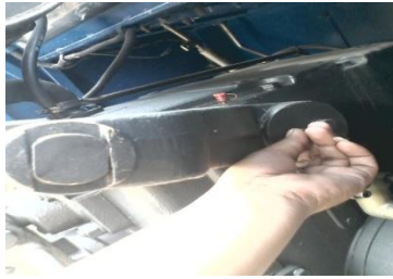
Gambar. 7 proses pelepasan baut pada lifting arm
