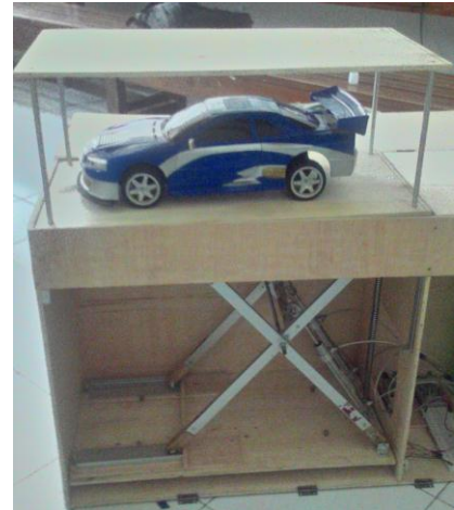
Gambar 14 Bagian Penggerak dan Lantai Lift
