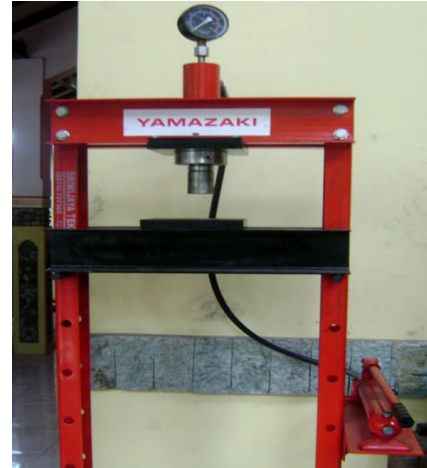
Gambar 5. Alat pengepres karet Merk YAMAZAKI dengan kapasitas 20 ton
