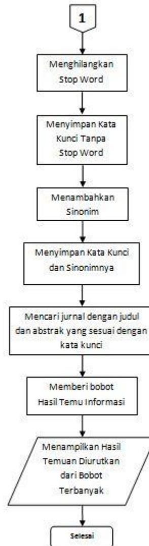
**Gambar 3** *Flowchart* Ekspansi Kueri (bagian 2)
