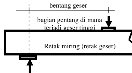
Gambar 2. Retak miring pada balok beton bertulang
