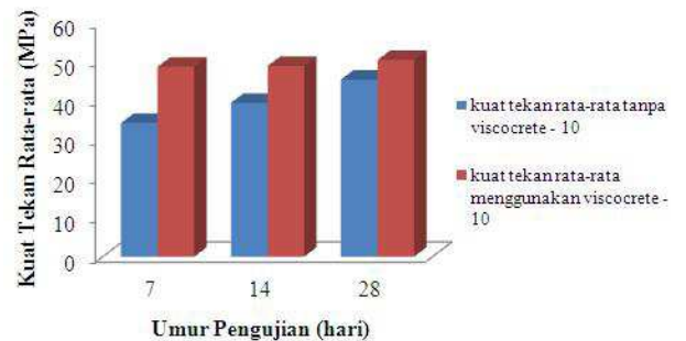
Gambar 3. Hubungan Antara Umur Pengujian dan Kuat Tekan Rata-rata Beton Mutu Tinggi (menggunakan Bahan Tambah Sika Viscocrete - 10 dan tanpa Bahan Tambah Sika Viscocrete - 10)
