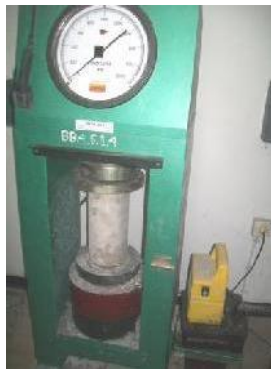
Gambar III.2. Pengujian kuat tekan silinder beton
