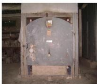
Gambar 13. Tungku Pembakaran Keramik (CV. Mustika Keramik, Klampok, Banjarnegara)
