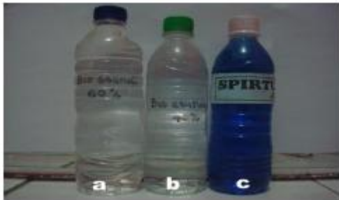
Gambar 5. Bahan bakar (a. Bioethanol kadar alkohol 60%; b. Bioetanol kadar alkohol 40 %; c. Spirtus )
