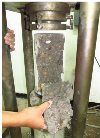
Gambar 4. Kondisi Beton Dengan Kandungan Lumpur Terlalu Tinggi
