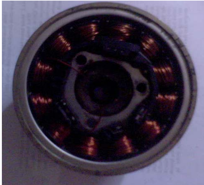
Gambar 1. Stator generator dengan 33 lilitan dan diameter kumparan 0,9mm
