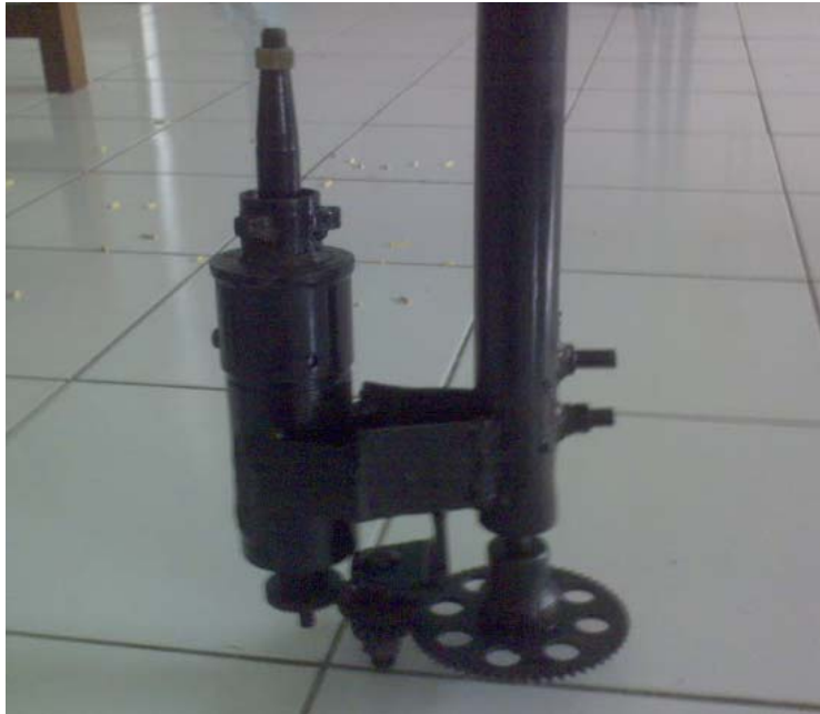
Gambar 7. Gambar gear box danudukan generator
