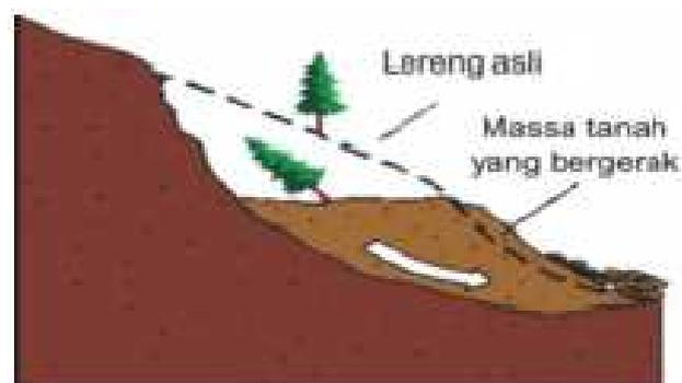
Gambar 1.3 Longsor rotasi adalah bergeraknya masa tanah dan batuan pada bidang gelincir berbentuk cekung (Vulkanologi dan Mitigasi Bencana Geologi, 2003)
