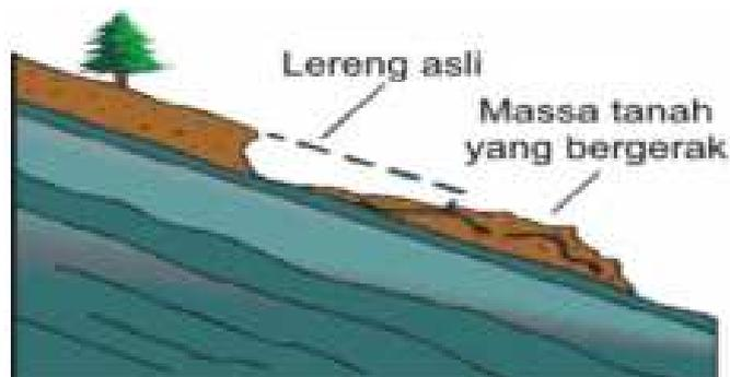
Gambar 1.2 Longsoran translasi adalah bergeraknya masa tanah dan batuan pada bidang gelincir berbentuk rata atau menggelombang landai (Vulkanologi dan Mitigasi Bencana Geologi, 2003)
