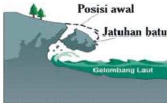
Gambar 1.5 Runtuhan batu terjadi ketika sejumlah besar batuan atau material lain bergerak ke bawah dengan jatuh bebas. Umumnya terjadi pada lereng yang terjal hingga menggantung terutama di daerah pantai. Batu-batu besar yang jatuh dapat menyebabkan kerusakan yang parah (Vulkanologi dan Mitigasi Bencana Geologi, 2003)
