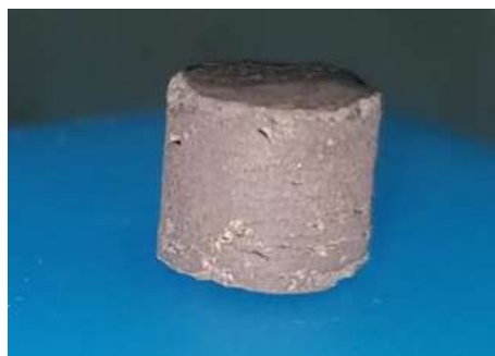
Gambar 6. Detail spesimen setelah proses sintering
