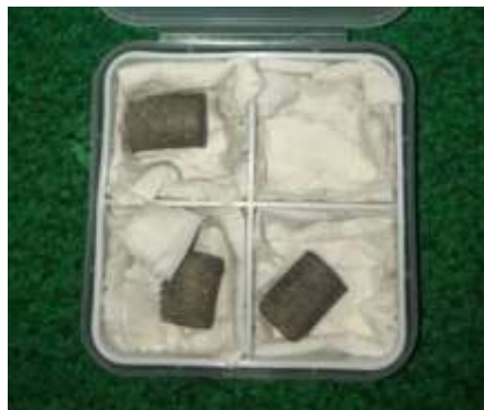
Gambar 5. Sampel spesimen setelah sintering
