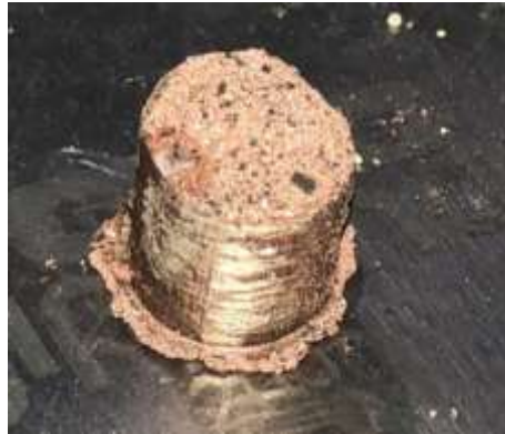
Gambar 4. Detail spesimen hasil dari proses pemadatan
