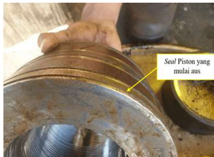
Gambar 1. Kondisi seal yang sudah aus
