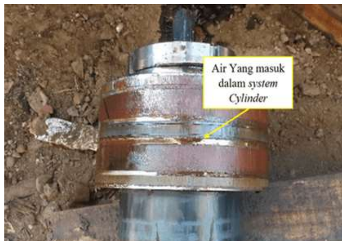
Gambar 2. Piston kemasukan air
