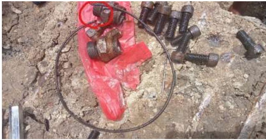
Gambar 10. O-Ring Travel Motor Yang Putus
