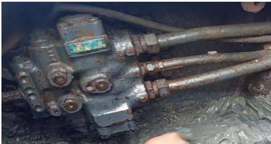
Gambar 19. Hose Hydraulic Ketika Sudah Terpasang
