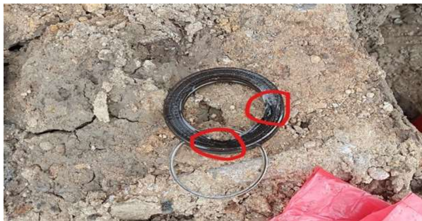
Gambar 11. Seal Pemisah Oli Travel Reducer Dengan Travel Motor yang Mengeras dan Robek
