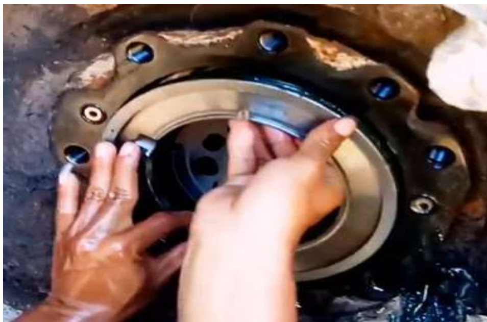
Gambar 17. Pemasangan Brake Piston
