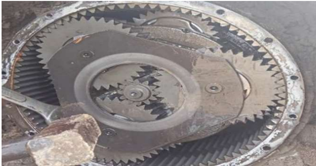
Gambar 13. Pemasangan Drive Shaft dan Planetary Gear
