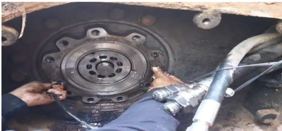
Gambar 4. Pelepasan Brake Piston
