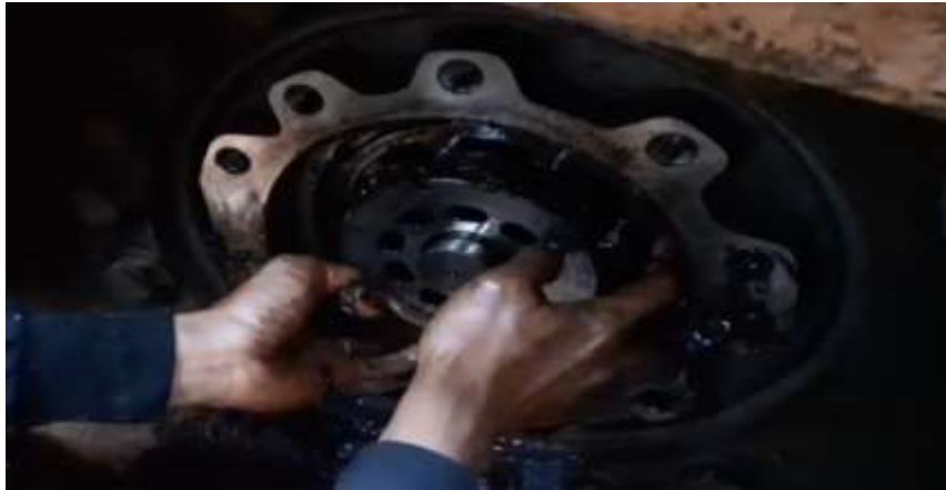
Gambar 5. Pelepasan Block Rotor
