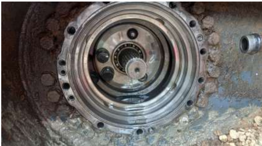
Gambar 6. Travel Motor Setelah Semua Komponen Terlepas Kecuali Shaft
