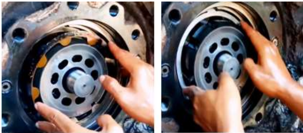
Gambar 16. Pemasangan Disc dan Plate
