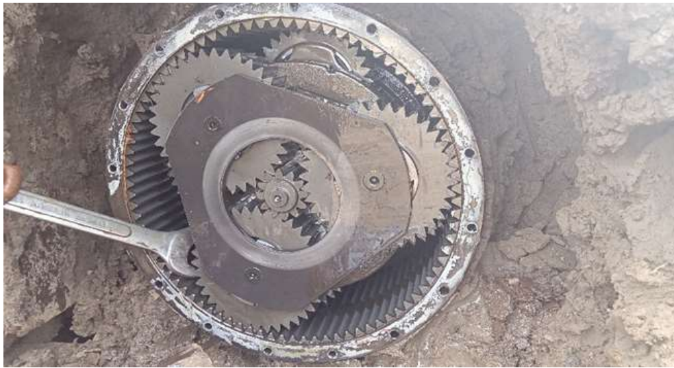
Gambar 8. Proses Mengeluarkan Planetary Gear
