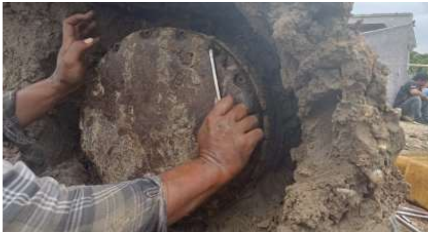
Gambar 7. Melepas Case Travel Reducer Menggunakan Hexagon Wrench
