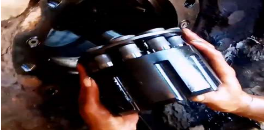
Gambar 15. Pemasangan Block Rotor , Disc Friction dan Pistin Shoe
