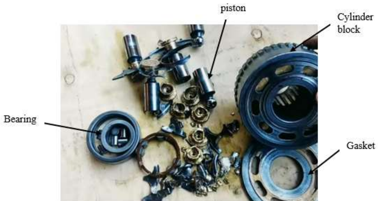
Gambar 7. Komponen pada motor swing
