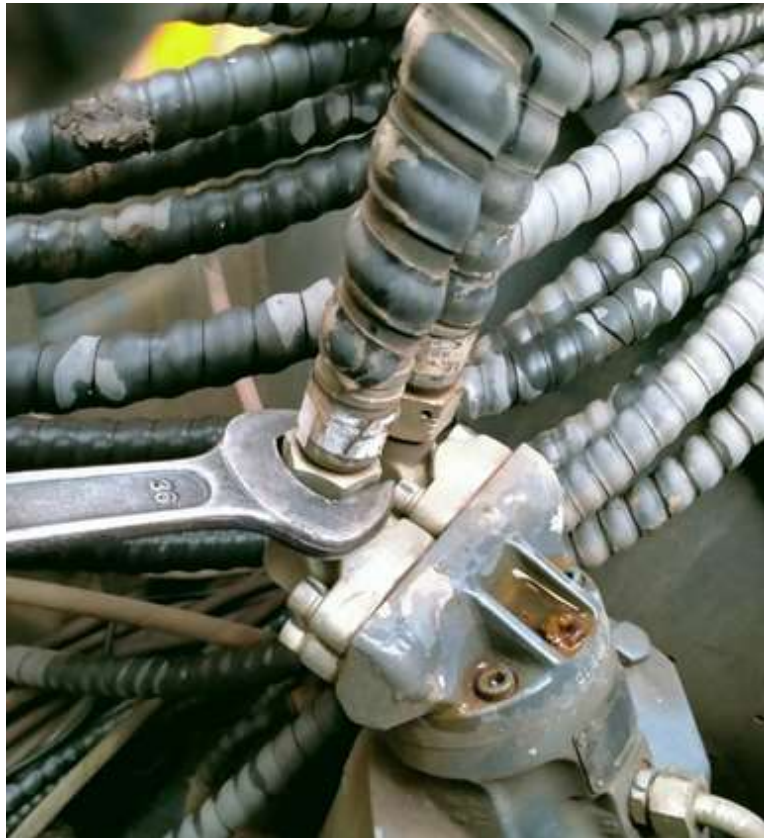
Gambar 4. Melepas selang oli hydraulic
