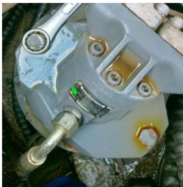
Gambar 9. Memasang baut pada kedua sisi motor swing
