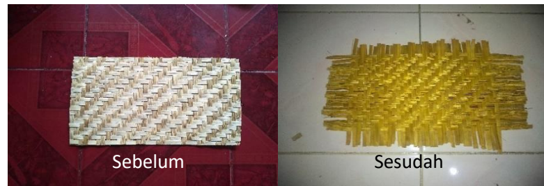
Gambar 2 Perbedaan Anyaman Bambu Sebelum dan Sesudah Proses Alkali
