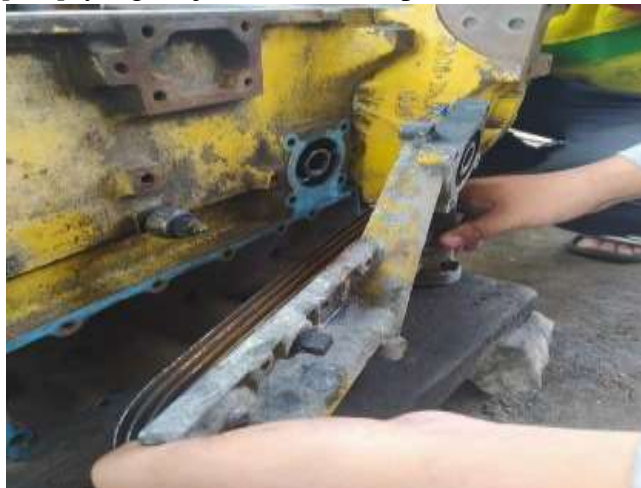
Gambar 4. Proses assembly oil cooler pada engine
