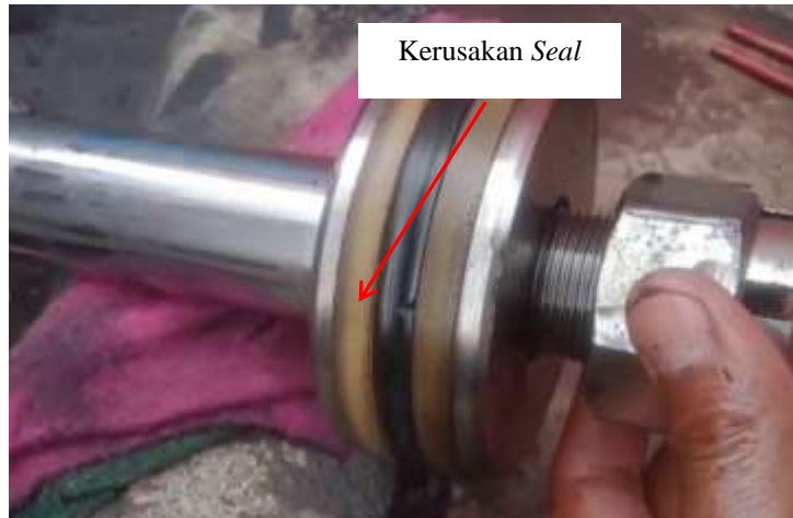
Gambar 2 Kerusakan Seal Piston
