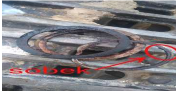
Gambar 13. Seal rod yang sudah kaku dan terdapat bagian yang sobek
