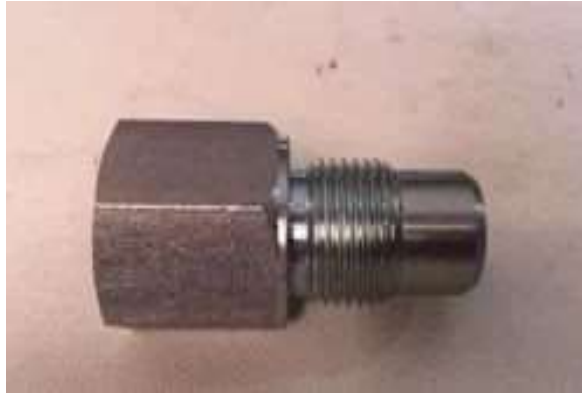
Gambar 8. Grease valve yang sudah dibersihkan
