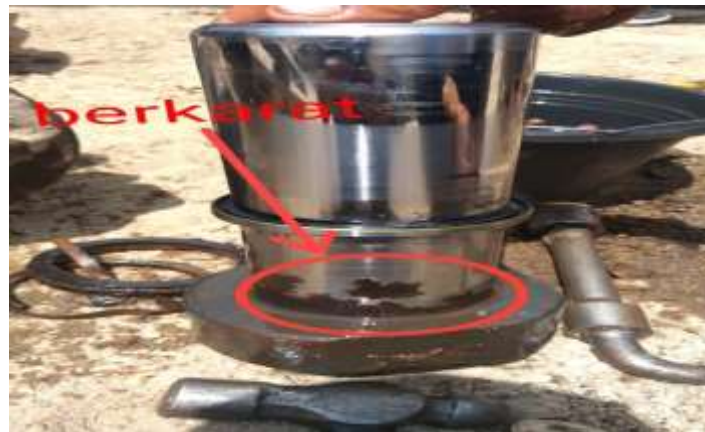
Gambar 14. Bagian crome pada rod yang berkarat
