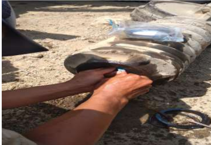
Gambar 4. 1 proses pemasangan seal dengan yang baru
