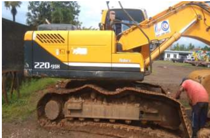
Gambar 15. Kerusakan seal rod track adjuster yang dialami unit Excavator Hyundai R220-9SH yang menyebabkan track shoe assembly kendur
