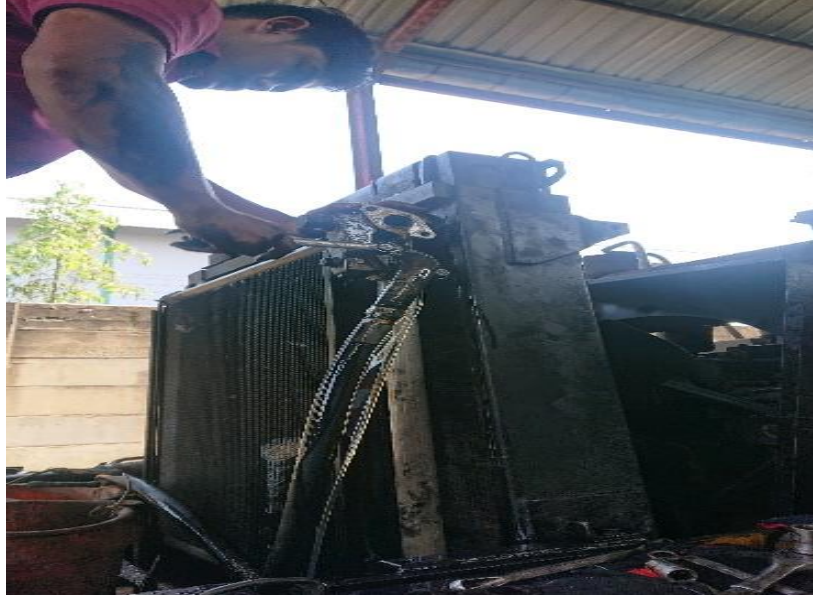
Gambar 11 pemasangan selang hidrolik
