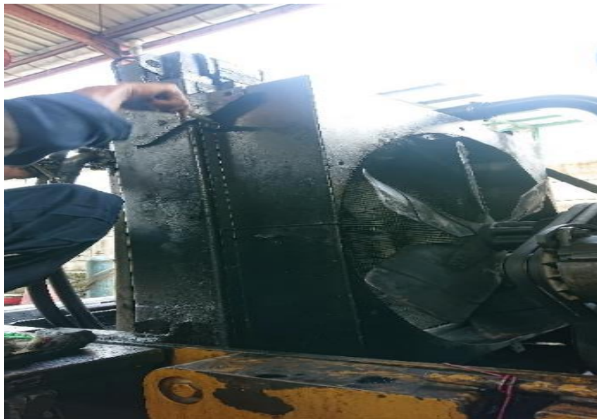
Gambar 1. Melepas Tutup Kipas Radiator
