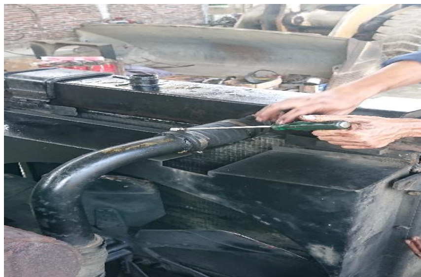
Gambar 10. pemasangan selang bagian atas
