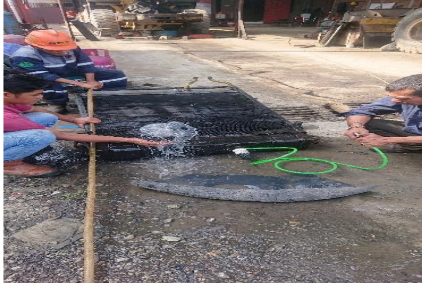
Gambar 5. Pengecekan Ulang Radiator
