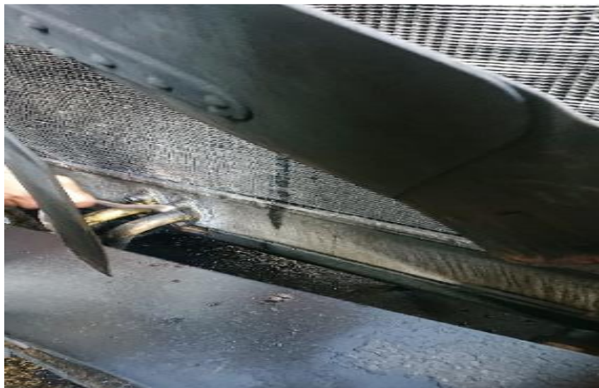
Gambar 2. Pelepasan Selang Bagian Bawah
