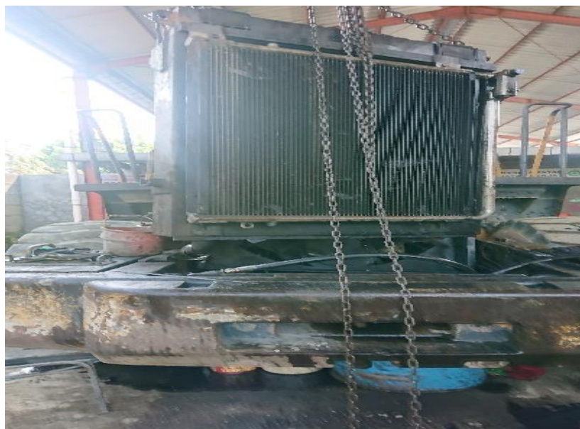
Gambar 4. Menurunkan Radiator Dari Unit Wheel Loader
