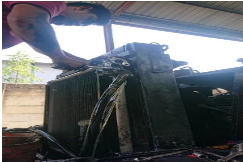
Gambar 4. Melepas Selang Input dan Output Oil Hydraulic
