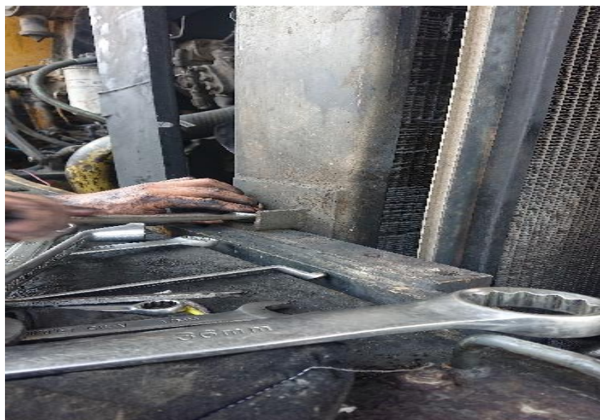
Gambar 8. Pemasangan baut radiator dengan wheel loader
