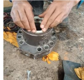
Gambar 7. Pemasangan Seals dan O-ring Pada Cylinder Head
