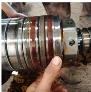
Gambar 2. Kerusakan Seals Pada Piston
