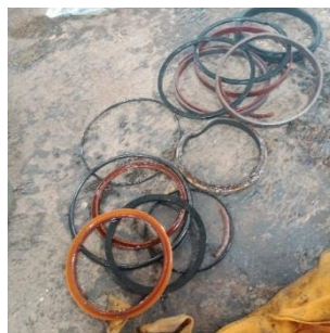
Gambar 3. Kerusakan Seals dan O-ring Pada Cylinder Head
