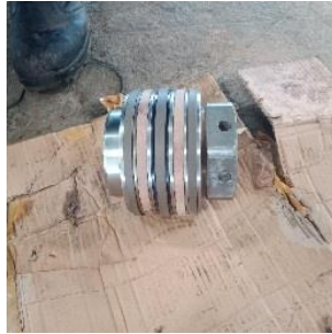
Gambar 6. Pemasangan Seals Pada Piston
