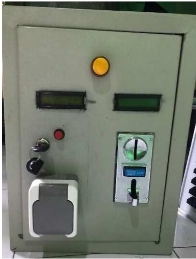
Gambar 6. Sistem Terminal Charger dengan Coin Acceptor
