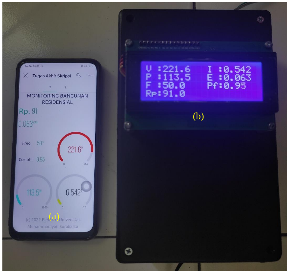
Gambar 11. Tampilan pada (a) Blynk dan (b) LCD 20x4
