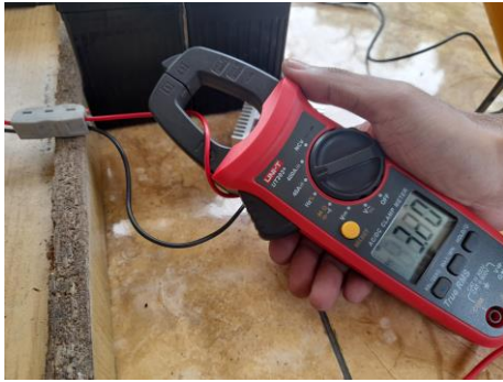
Gambar 8. Pengukuran Arus Menggunakan Clampmeter
