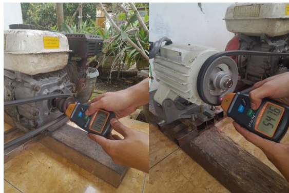
Gambar 4. Pengukuran Rpm Mesin dan Generator menggunakan Tachometer
