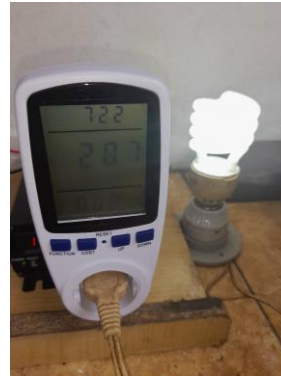
Gambar 9. Pengukuran Nilai Beban dan Frekuensi Tegangan Menggunakan Wattmeter
