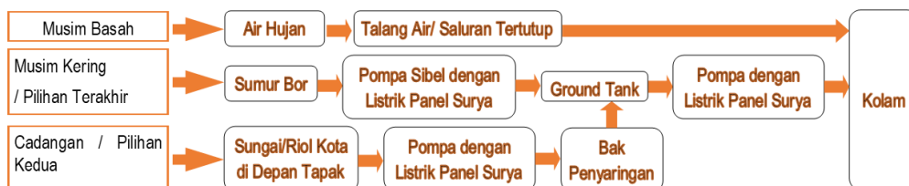
Gambar 30 Skema Pengisian Air Kolam Sumber : Analisa Pribadi, 2022
