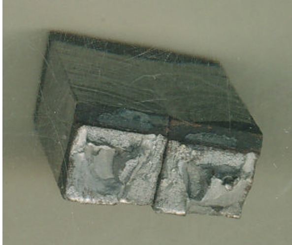
Gambar 4.8. Patahan spesimen tempering 200 °C
