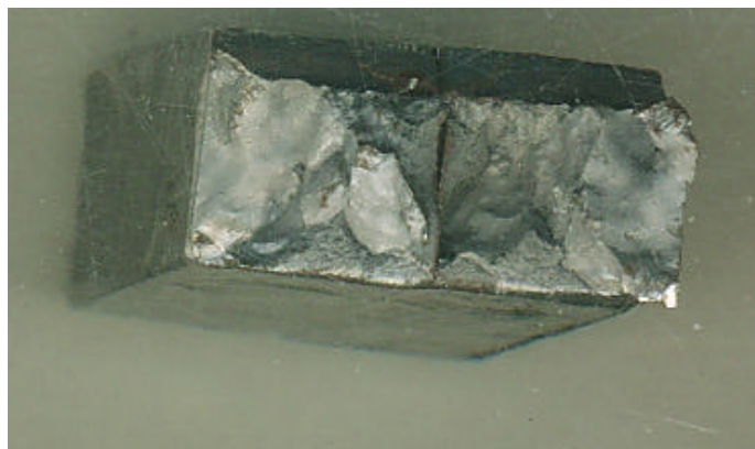
Gambar 4.9. Patahan spesimen tempering 400 °C
