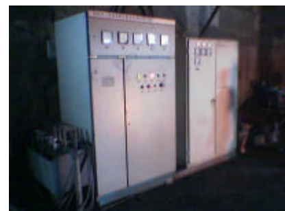
Gambar 3.7. Pengontrolan suhu dapur induksi (CV. Sinar Super Baja, 2010)
