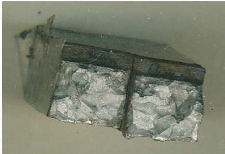
Gambar 4.10. Patahan spesimen tempering 600 °C
