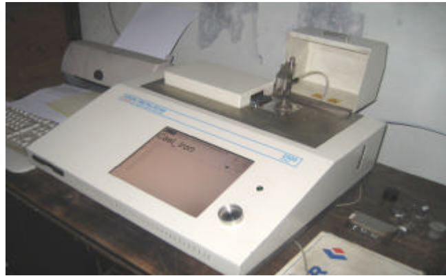
Gambar 3.16. Alat uji komposisi kimia / spectrometer (Lab. PT. BAJA KURNIA , 2010)
