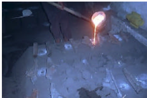
Gambar 3.8. Penuangan baja cair ke dalam cetakan dengan cara konvensional (CV. Sinar Super Baja, 2010)
