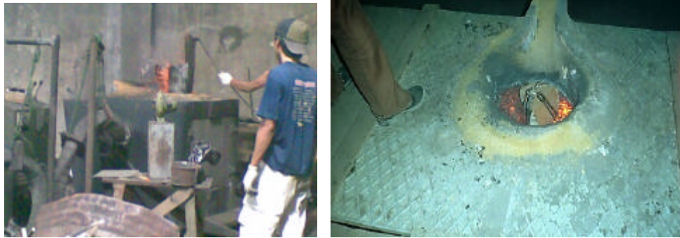
Gambar 3.3. Pemanasan tanur induksi (CV. Sinar Super Baja, 2010)
