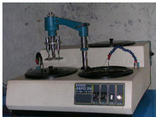
Gambar 3.12. Mesin penghalus / grinding (Lab. D3 UGM, 2010)
